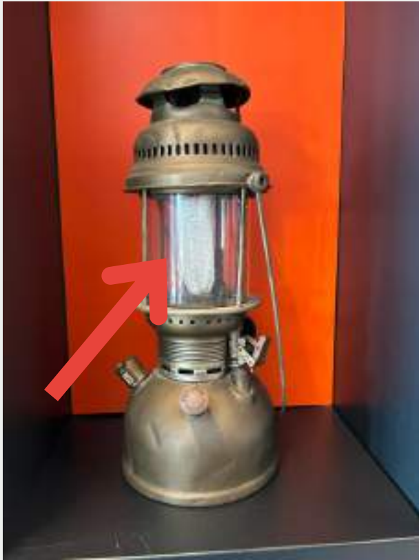
Gloeikousje (olielampkous), historisch vervaardigd uit asbestvezels en later geïmpregneerd met radioactieve thoriumverbindingen (thoriumoxide).
